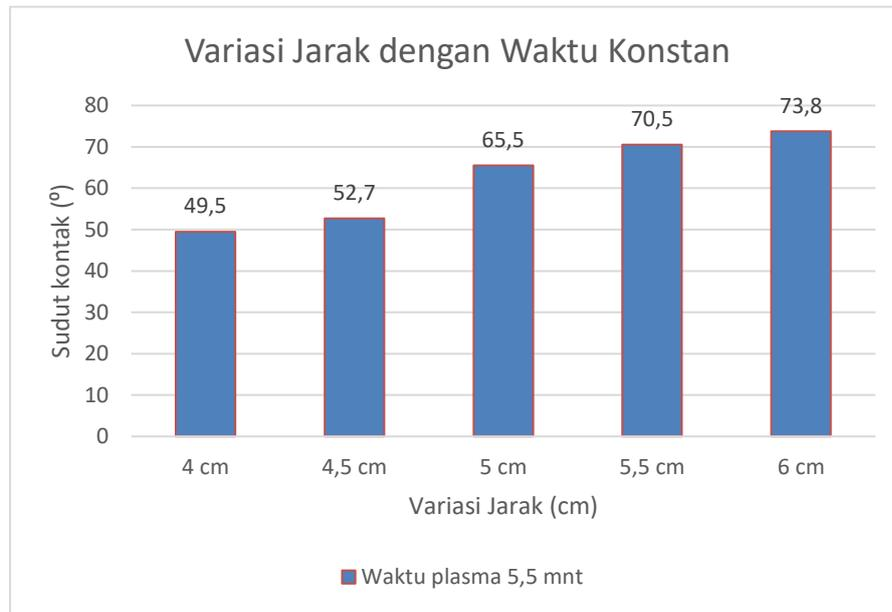
Gambar 7 Grafik sudut kontak terhadap variasi jarak dengan waktu konstan
